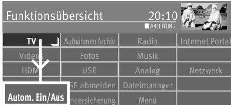
Der Ausschalt Timer schaltet das TV-Gerät nach einer von Ihnen eingegebenen Zeitdauer (15 min. Stufen) ab.
